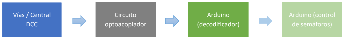
Figura 13: Esquema de conexión del decodificador
